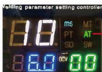
Індукційний режим точкового зварювання АТ.
