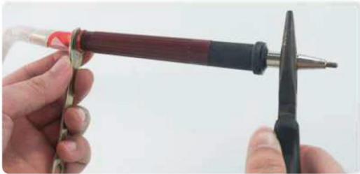
А: За допомогою гайкового ключа зафіксуйте гайку на кінці руків'я, а плоскогубцями затисніть електрод і викрутіть його проти годинникової стрілки.
