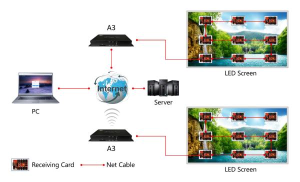
2.异步一对一控制:通过网线连接、Wi-Fi 连接和 U 盘的方式更新节目。局域网(集群)控制可通过网线连接和 Wi-Fi 桥接两种方式接入局域网网络。
