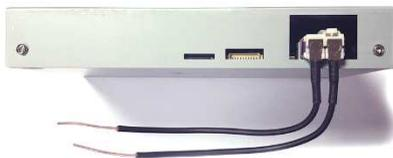
GPS антенна должна быть установлена в подпанельное пространство, не должна устанавливаться на магнитолу и кабель не должен быть скручен в кольцо. Если автомобиль имеет обогрев лобового стекла, то антенну необходимо устанавливать на правую стойку или левую стойку, в месте, где отсутствует обогрев.
