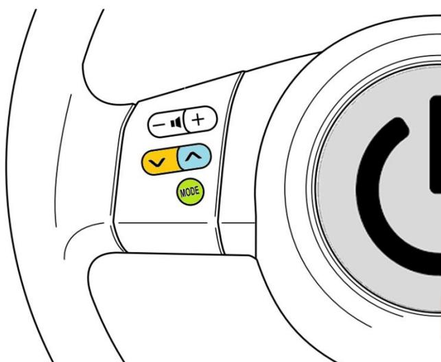
En el **modo combinado** de manejo el usuario puede activar cualquiera de las cámaras conectadas con ayuda de botones originales ubicados en el volante. Para esto se utilizan tres botones: **«MODE»**, **«SEEK+»**, **«SEEK-»**. Más abajo están descritos los algoritmos de manejo y selección de diferentes modos con ayuda de botones originales en el volante.
