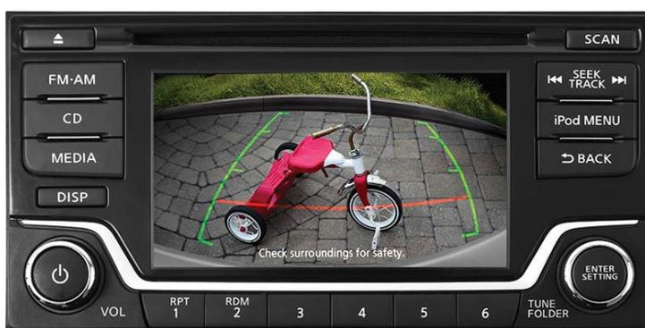
В зависимости от места установки камеры, угла обзора камеры, статические и поворотные линии будут не информативными – их потребуется настроить в диагностическом меню магнитолы.
