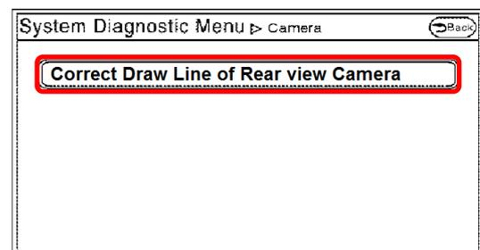
Активируется изображение с подключенной камеры с OSD кнопками для регулировки линий и настройки изображения камеры. Выровняйте линии относительно центра изображения и проведите настройку линий относительно следующего изображения для настройки.
