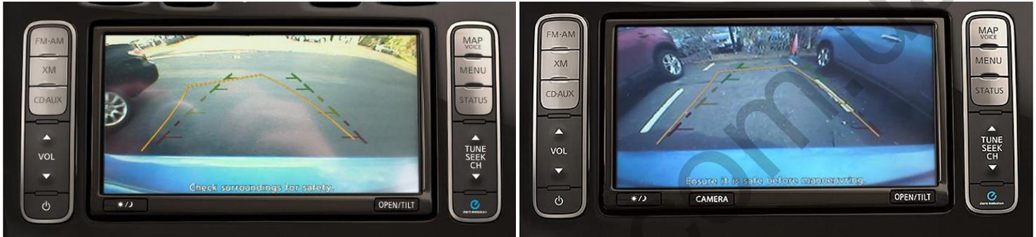
В зависимости от места установки камеры и угла обзора камеры (напр., угол обзора неудачный), статические и поворотные линии не будут информативными – в этом случае их потребуется настроить в диагностическом меню магнитолы.
