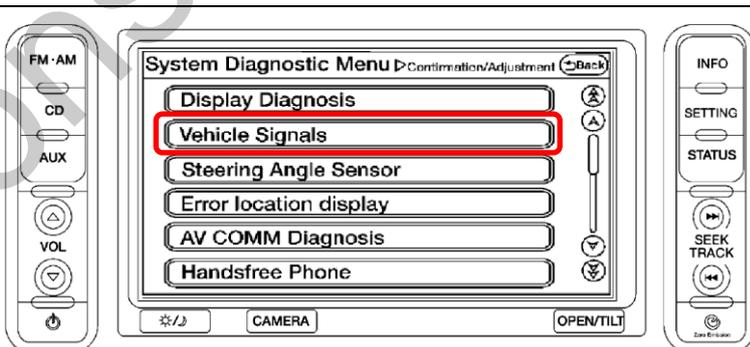
В появившемся диалоговом окне следует проверить сигнал **Reverse**. Если при включении заднего хода появляется надпись **ON**, а при выключении она исчезает – всё в порядке. Если этого не происходит, используйте серый провод **REV** на нашем кабеле.
