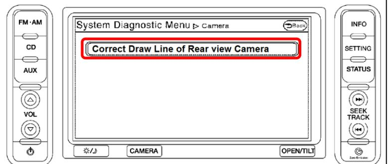
Активируется изображение с подключенной камеры с OSD кнопками для регулировки линий и настройки изображения камеры. Выровняйте линии относительно центра изображения и проведите настройку линий относительно следующего изображения.
