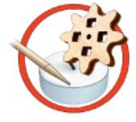
**UKR** Змастіть деталь звичайною свічкою (потрійте об свічку). **ENG** Lubricate the part with a standard candle (rub it against a candle). **DEU** Reiben Sie das Teil mit einer einfachen Kerze etwas ein.
