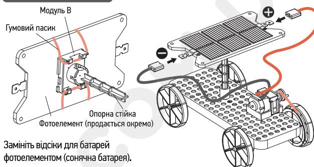
Замініть відсіки для батареї фотоелементом (сонячна батарея).
