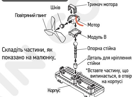
Поверніть гвинт вверх. Приєднайте до батарей, і сила тяги гвинта буде спрямована вверх.
