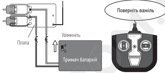
Після перевірки моторів від'єднайте проводи, які ви підключили при виконанні кроку 1. Від'єднайте проводи обережно, щоб не пошкодити їх.
