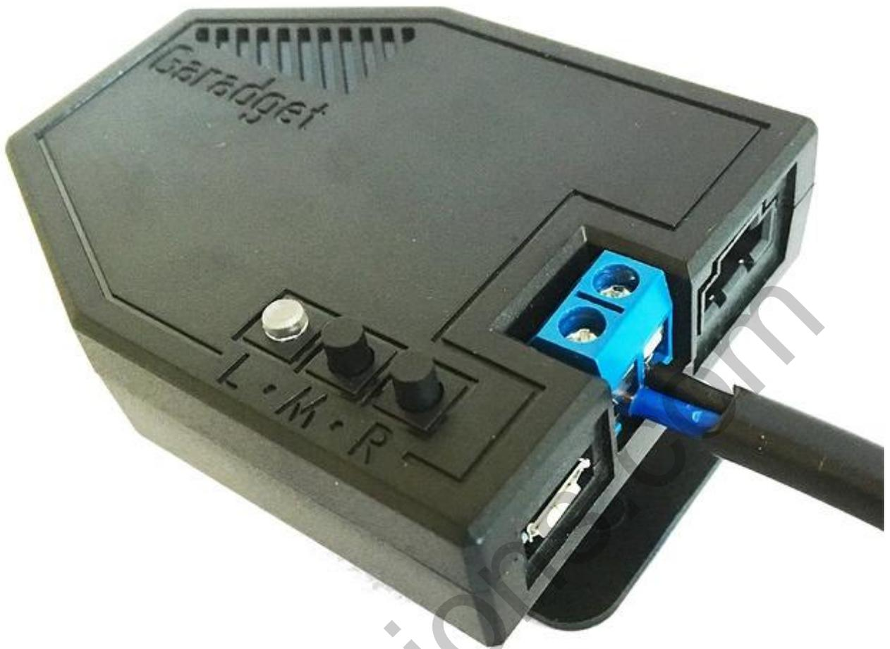
Otro cabo del cable conecte a los bornes del mecanismo de apertura/cierre de puerta. Si el cable incluido en el paquete no alcanza, puede utilizar para estos fines un cable ordinario de dos hilos 18/2.
