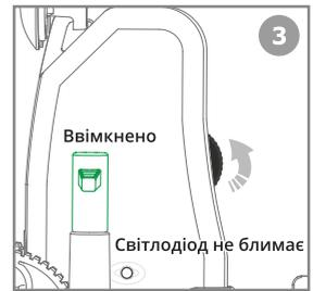
4. Тепер протестуйте металощукач. Перемістіть робота так, щоб основа металощукача була поруч з будь-яким металевим предметом. Якщо металощукач працює коректно, пролунає звуковий сигнал, і засвітиться зелена лампочка, вказуючи на те, що робот перебуває поблизу металевого предмета.
