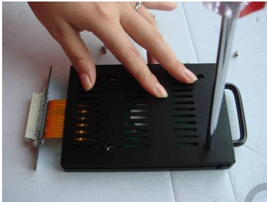
6. Установите разъем на задней части корпуса жесткого диска. Теперь жесткий диск SATA установлен в корпус жесткого диска.
