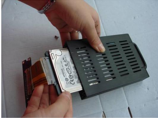
5. Установите жесткий диск в монтажный кронштейн через отверстия на корпусе жесткого диска. Устанавливайте жесткий диск плотно, в противном случае он может быть поврежден из-за вибрации, что приведет к потере данных.
