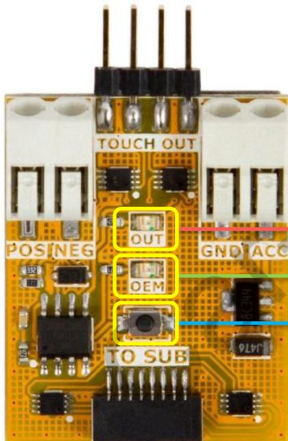
Светодиод «**OUT**» - состояние контроллера, штатное тач стекло коммутируется на выход «**TOUCH OUT**»
