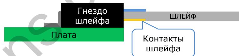
При подключении шлейфа от коммутационной платы к плате штатного монитора следует соблюдать ориентацию шлейфа, а именно, с какой стороны должны находиться контакты подключаемого шлейфа.
