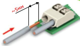
Для отключения провода от гнезда вам потребуется маленькая отвертка или попросту шариковая ручка. Нажмите инструментом на кнопку-впадину напротив провода и аккуратно потяните за провод. Не прилагайте лишних усилий во избежание повреждения устройства.
