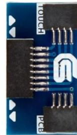
Плата коммутации для подключения к 4-контактным шлейфам с шагом 1мм или 8-ми контактным шлейфам с шагом 0,5мм
