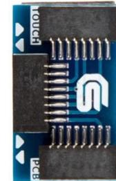
Плата коммутации для подключения к 8-контактным шлейфам с шагом 1мм или 16-контактным шлейфам с шагом 0,5мм
