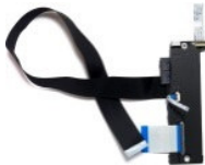
Плата адаптера с кабелем для подключения монитора к видеоинтерфейсу
