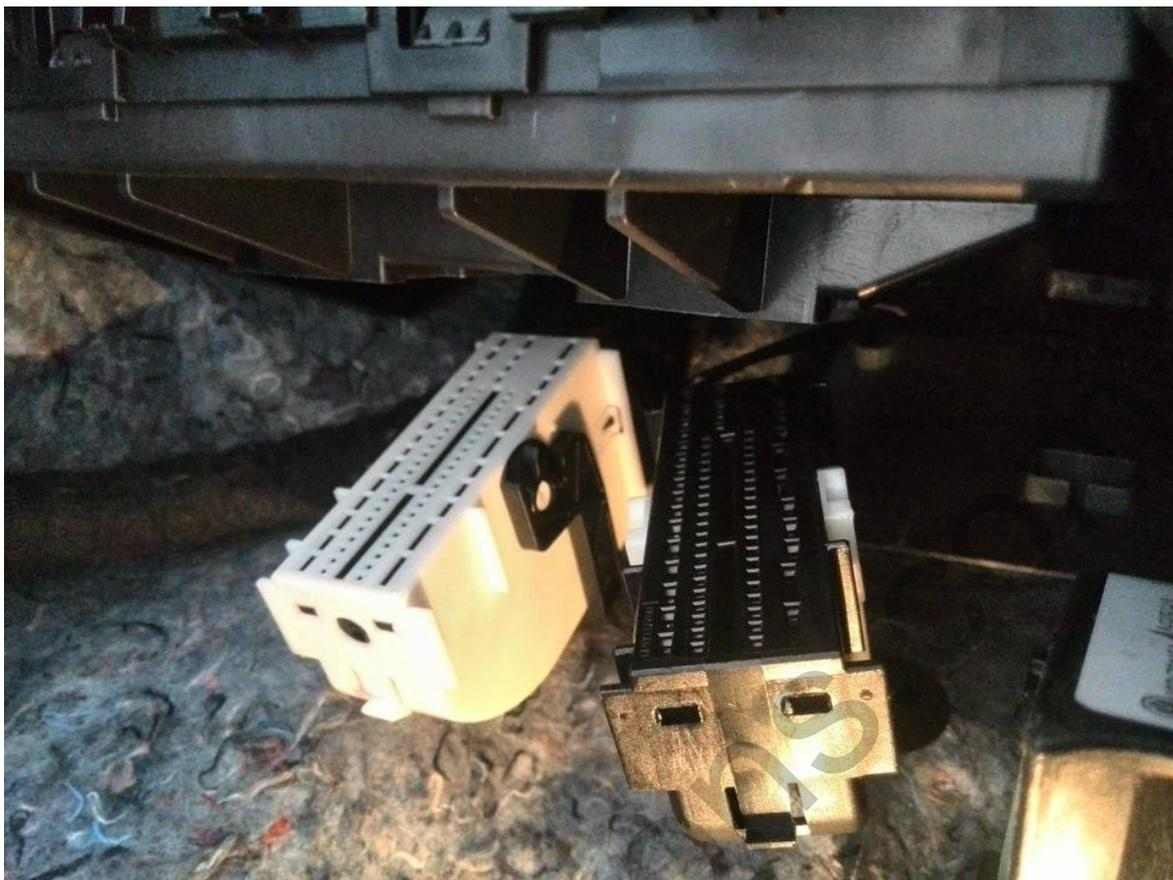
Снимаем кожух с белого разъёма. По бокам со стороны проводки есть две защелки.
