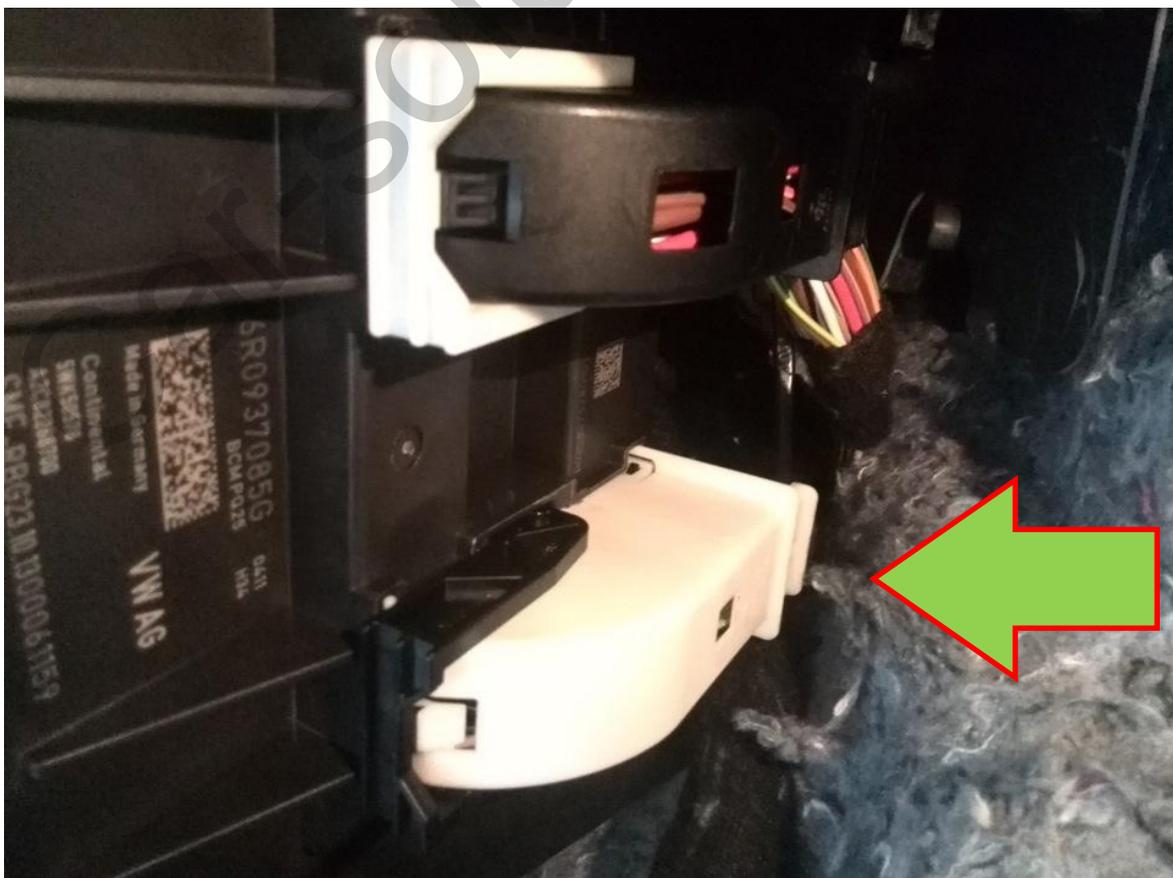
Места очень мало, работать тяжело, поэтому советуем снимать водительское сидение. Далее поднимаем защелки вверх и отключаем разъёмы. Подключение будет проводиться к белому разъёму.
