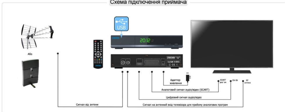
Схема підключення приймача
