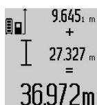
Для отрашивания суммы обоих измерений нажмите кнопку результата **6**. Расчет суммы отображается в строках измеренных значений **a**, сумма отображается в строке результата **c**.
