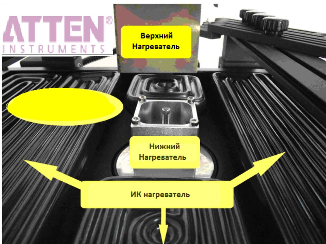
Термовоздушный ремонтный комплекс AT8235 обладает тремя зонами нагрева: верхним нагревателем, нижним нагревателем, и инфракрасным нагревателем. При нагреве, согласно данным о максимально возможной температуре РСВплат, температура нагрева не должна превышать 110°С, для предотвращения деформации печатной платы.
