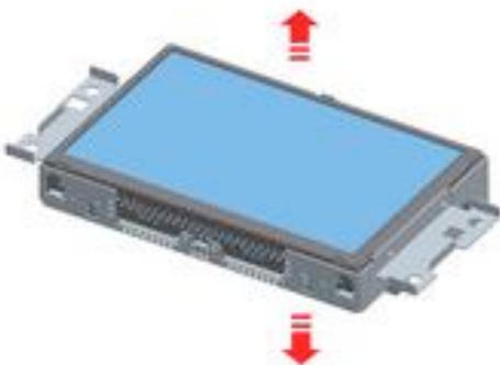
Разъедините переднюю и заднюю рамки монитора.
