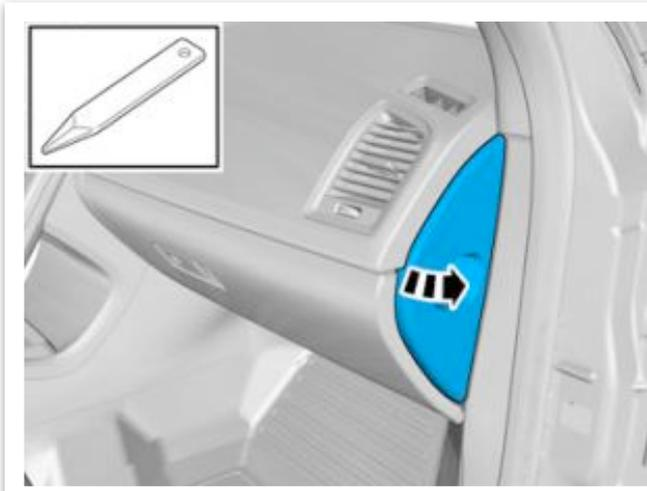
Снимите боковую планку (будьте осторожны с разъемом подушки безопасности SRS).
