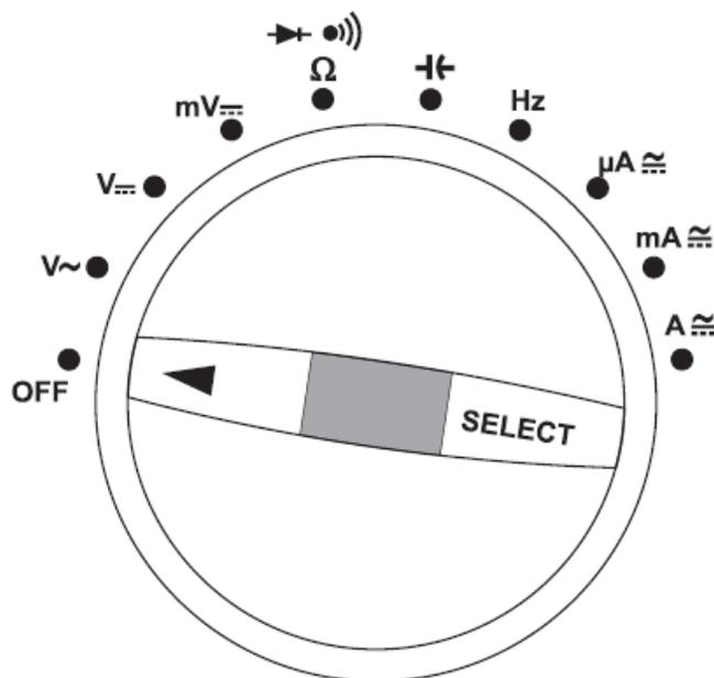
При помощи поворотного переключателя оператор может выбирать функции. Приблизительный диапазон для каждой задачи устанавливается вручную.
