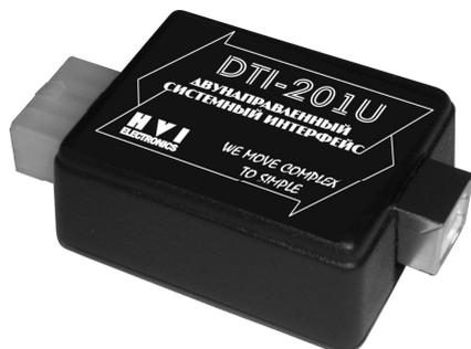
Функциональное назначение: контроллер предназначен для безопасного подключения любого, производимого нами оборудования (имеющего соответствующую возможность), к USB порту компьютера.
