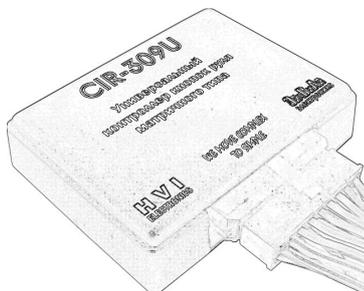
**Функциональное назначение:** CIR-309U служит интерфейсом между резистивной матрицей кнопок руля автомобиля и командами, которые должно выполнять внешнее устройство под их управлением. Кроме этого, устройство имеет цифровой вход данных, благодаря которому, команды управления можно передавать от любого другого совместимого устройства, например, декодера CAN шины.
