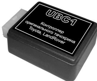
**Функциональное назначение:** Данное устройство обеспечивает передачу координат, соответствующих месту нажатия оригинального «тачскрина» автомобилей Land Rover и Toyota, навигационному устройству. А также осуществляет управление коммутатором GVIF интерфейса с помощью штатной кнопки, активирующей режим отображения штатного навигационного устройства на мониторе водителя.
