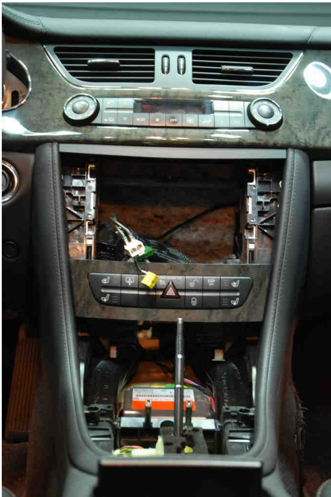
Центральная консоль с демонтированным монитором.
