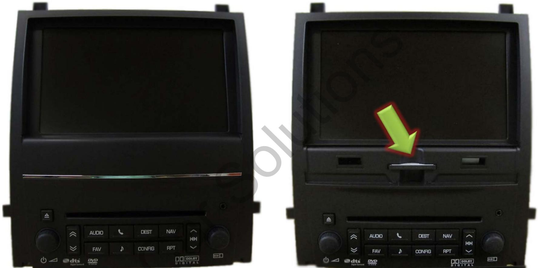
На рисунке представлен внешний вид монитора, которым оборудованы автомобили 2009-2012 годов выпуска. В этих мониторах носителем навигационных карт является CF-карта памяти, которая устанавливается в прорезь за фальш-панелью, указанную на рисунке зеленой стрелкой. Итак, первый шаг вы сделали –монитор демонтировали. Приступим к установке.
