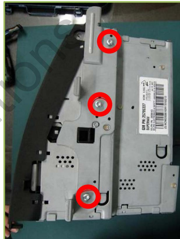
На рисунке представлен внешний вид монитора, которым оборудованы автомобили 2006-2009 год ов выпуска. В этих мониторах носителем навигационных карт является DVD-диск, который устанавливается в прорезь, указанную на рисунке зеленой стрелкой. Итак, первый шаг вы сделали –монитор демонтировали. Ну что же, приступим к установке. Первым делом выкрутите винты, выделенные красным на рисунке.
