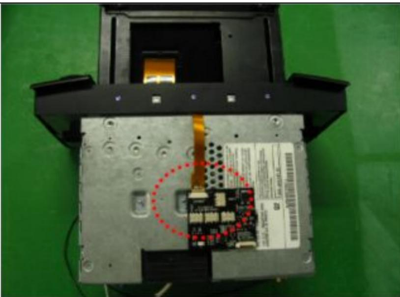
Подключите узкий шлейф к коммутационной плате. Плату закрепите на нижней части корпуса при помощи двухсторонней клейкой ленты на вспененной основе.
