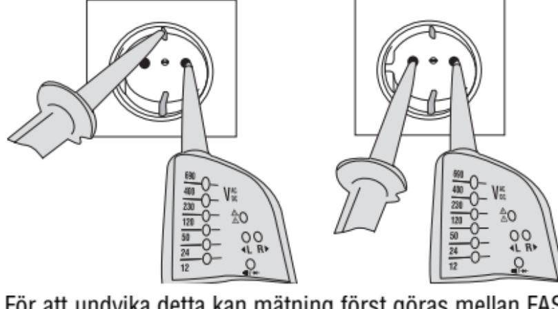
För att undvika detta kan mätning först göras mellan FAS och NOLLA, (L och N) i c:a 5 sekunder. Direkt därefter kan testet göras mellan fas och jord, (L och PE) utan att reläet löser ut.
