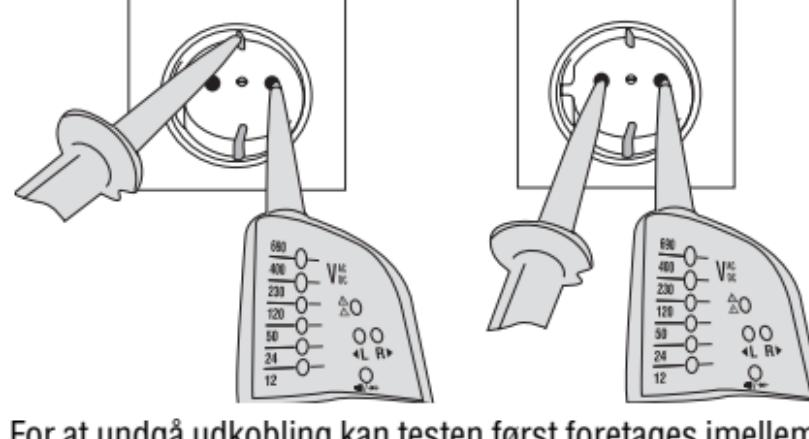
For at undgå udkobling kan testen først foretages imellem fase og nul, (L og N) (i ca. 5 sekunder). Umildbart herefter kan testen foretages imellem fase og jord, (L og PE) uden at relæet udkobler.
