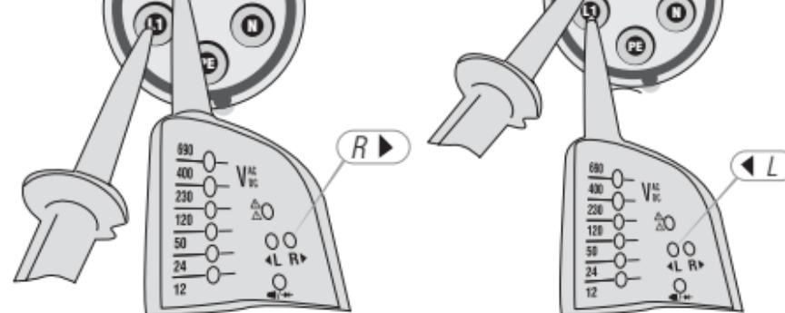
R ► signifie que la phase supposée être L1 est la phase réelle L1 et que la phase supposée être L2 est la phase réelle L2.
