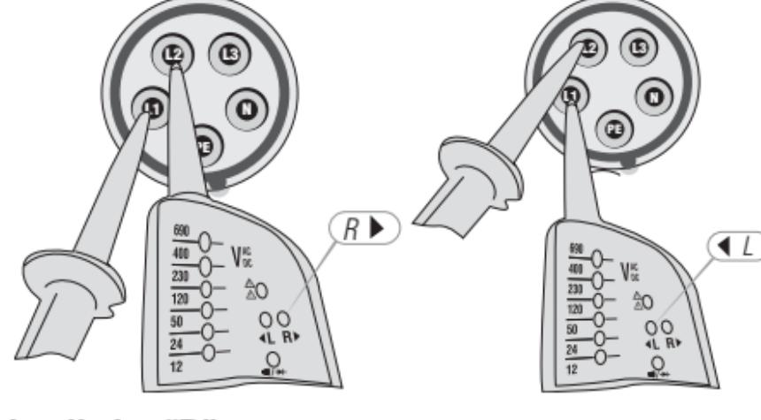
**Lysdioden "R"** (nr. 6) visar att den förmodade L1 är den faktiska L1 och att den förmodade L2 är den faktiska L2. Detta innebär rätt fasföldj.
