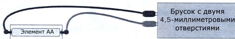
Рисунок 4. Использование деревянного бруска для защиты разъемов-"бананов" батареи от коротких замыканий.
