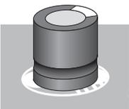
Електронна деталь, яка може накопичувати електричну енергію, щоб пізніше її віддати (розряджати). Використовується з іншими електронними деталями, наприклад, резисторами або котушками, щоб контролювати накопичення (зберігання) та віддавання електрики. Для позначення ємності використовуються фаради (Ф). Програмований роботомобіль використовує конденсатори ємністю 100 мкФ та 1000 мкФ.
