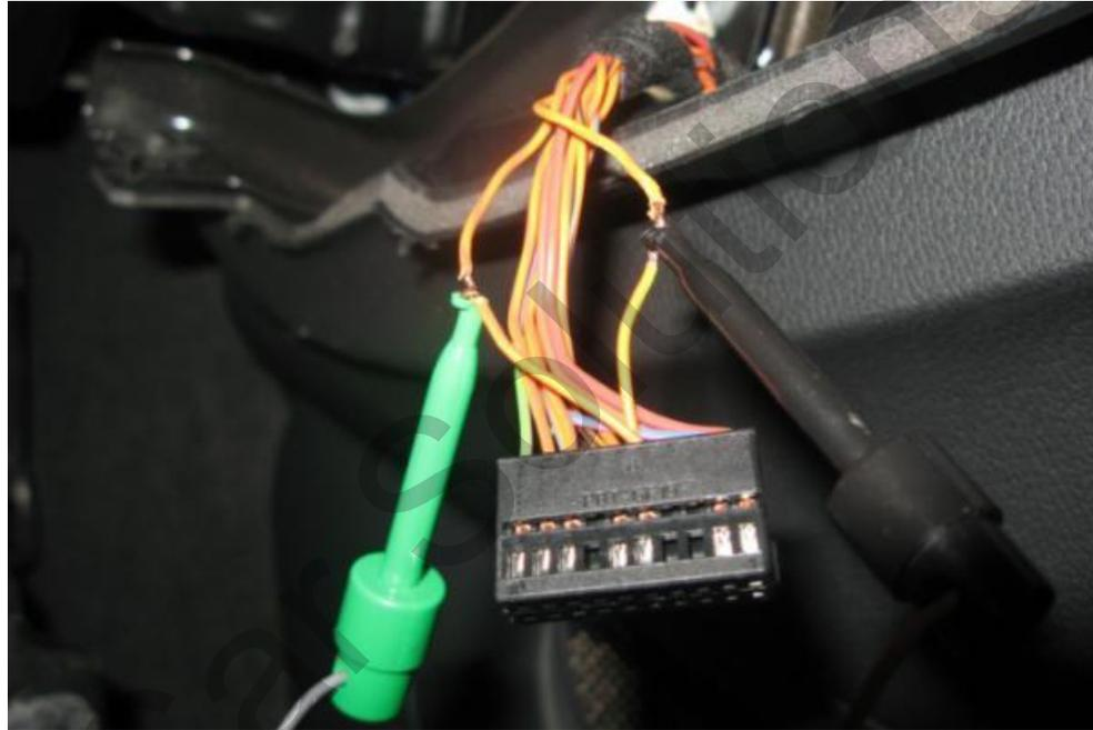
Подключение к шине CAN COMFORT должно производиться в соответствии со схематикой автомобиля в каждом отдельном случае во избежание поломки агрегатных узлов автомобиля. Выше показан пример подключения к шине CAN COMFORT в автомобиле Audi Q7 2010 г. в.. Подключение производилось к красному 20-контактному коннектору (*коннектор отключили от панели управления кондиционером*), с которого сняли красный кожух и подключились к проводам : #15 – CAN High, # 5 – CAN Low.
